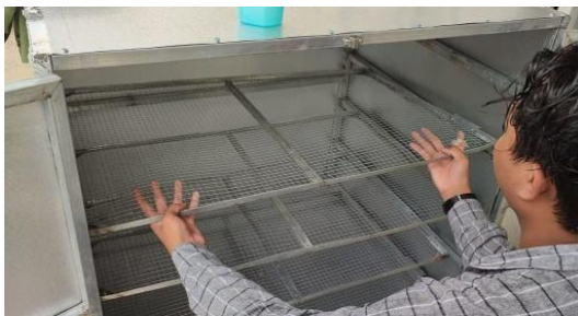
Gambar 5. Pemasangan tray kawat berlubang untuk pemanasan tipe langsung maupun tambahan Loyang Sumber: dokumen pribadi, 2022
