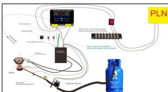
Gambar 3. Sistem pemanas menggunakan modul pemanas gas otomatis dan solenoid valve
